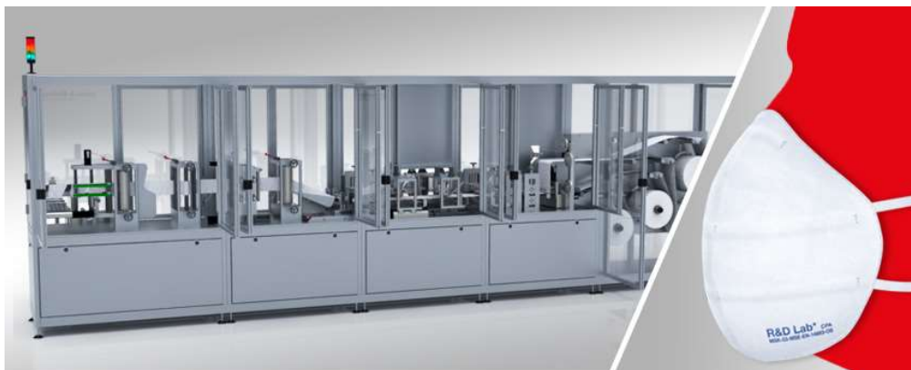
Jonas & Redmann: Anlage zur Massenproduktion von Corona SARS-Cov-2 Pandemie Atemschutzmasken.
